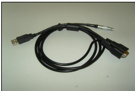
图 2-6 数据通讯电缆
